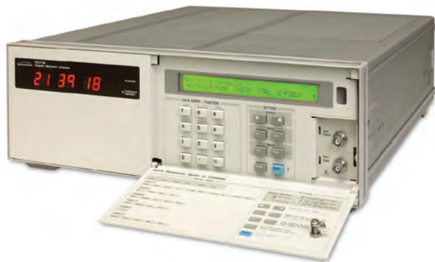
Obr. 2: Pro generování časových stupnic TP a FEL byly použity cesiové hodiny Microsemi 5071A
