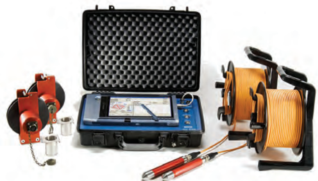
Obr. 4: Zkušební zařízení pro zkoušku integrity betonových pilot metodou CHA
