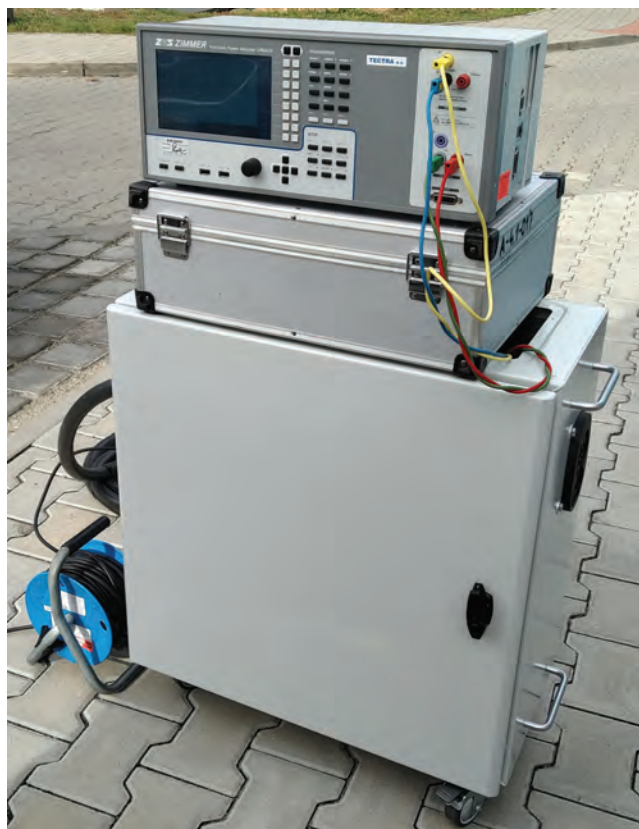
Obr. 5: Pohled na zapojený kabelový přípravek s analyzátozem
