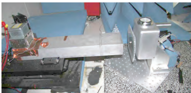
Obr. 25: Měření výkonu magnetronu na principu měření tlaku elektromagnetického záření, NIST [32]
