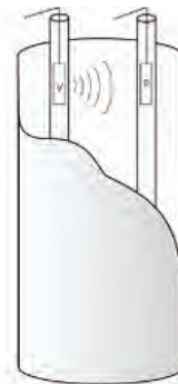
Obr. 2: Schematické znázornění páru trubek a signálu poslaného z vysílače (V) k přijímači (P)
