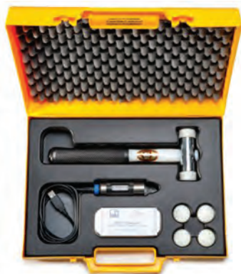
Obr. 1: Zkušební zařízení pro zkoušku integrity betonových pilot metodou PIT
