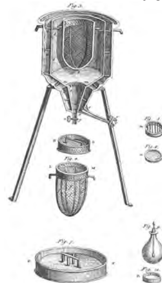
Obr. 2: První led-kalorimetr na světě vynalezen Lavoisierem a Laplacem [4]
