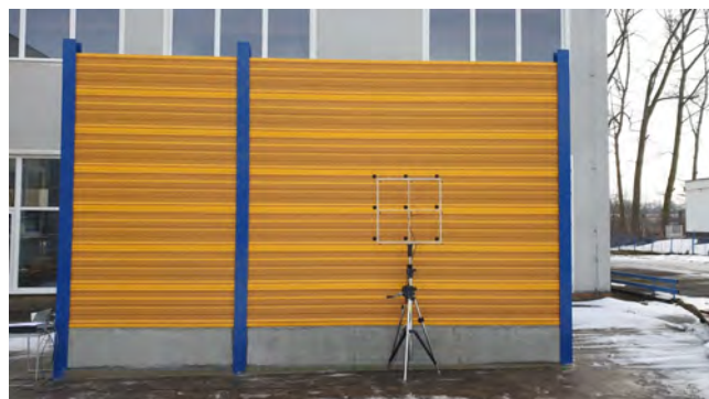
Obr. 1: Měření vzduchové neprůzvučnosti clony fěrovou a odpovídající metodou Adrienne podle EN 1793-6:2018 [1] na zkušebním polygonu TZÚS Praha, s.p., pobočka Teplice
