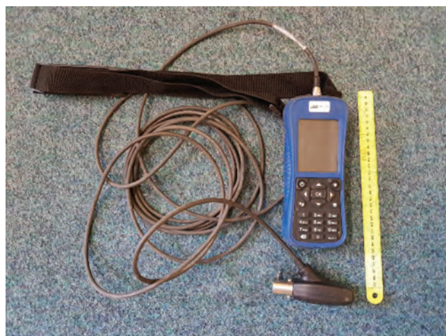
Obr. 4: Vyhodnocovací jednotka, kabel a snímač EMI-měřidla MF Pro (PVK)
