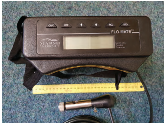
Obr. 3: Vyhodnocovací jednotka, kabel a snímač EMI-měřidla FLO-MATE 2000 (BVK)
