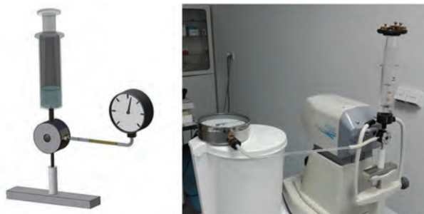
Obr. 4: Etalonové zařízení s modelovým okem (vlevo) a měření na bezkontaktním tonometru
